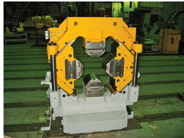
FDFD с пружинным возвратом (подъемом) верхнего корпуса для пресса ус. 10 МН (Германия)
