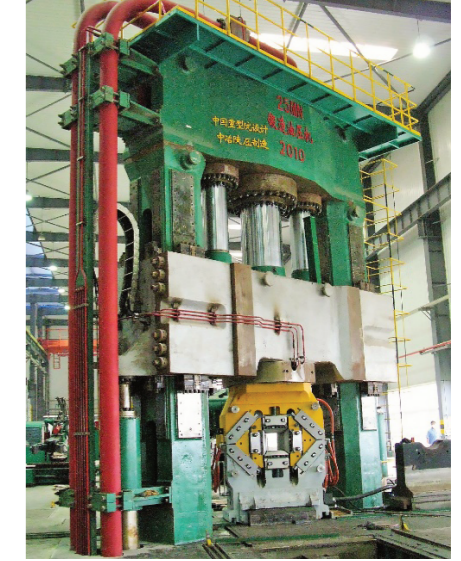
Использование ковочного блока на гидравлических прессах ус. 25МН и 45МН (Китай)
