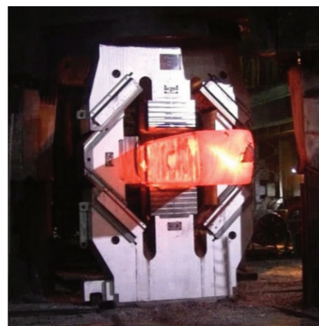
Ковка поковки квадратного сечения в FDFD на прессе ус. 30 МН (Япония)
