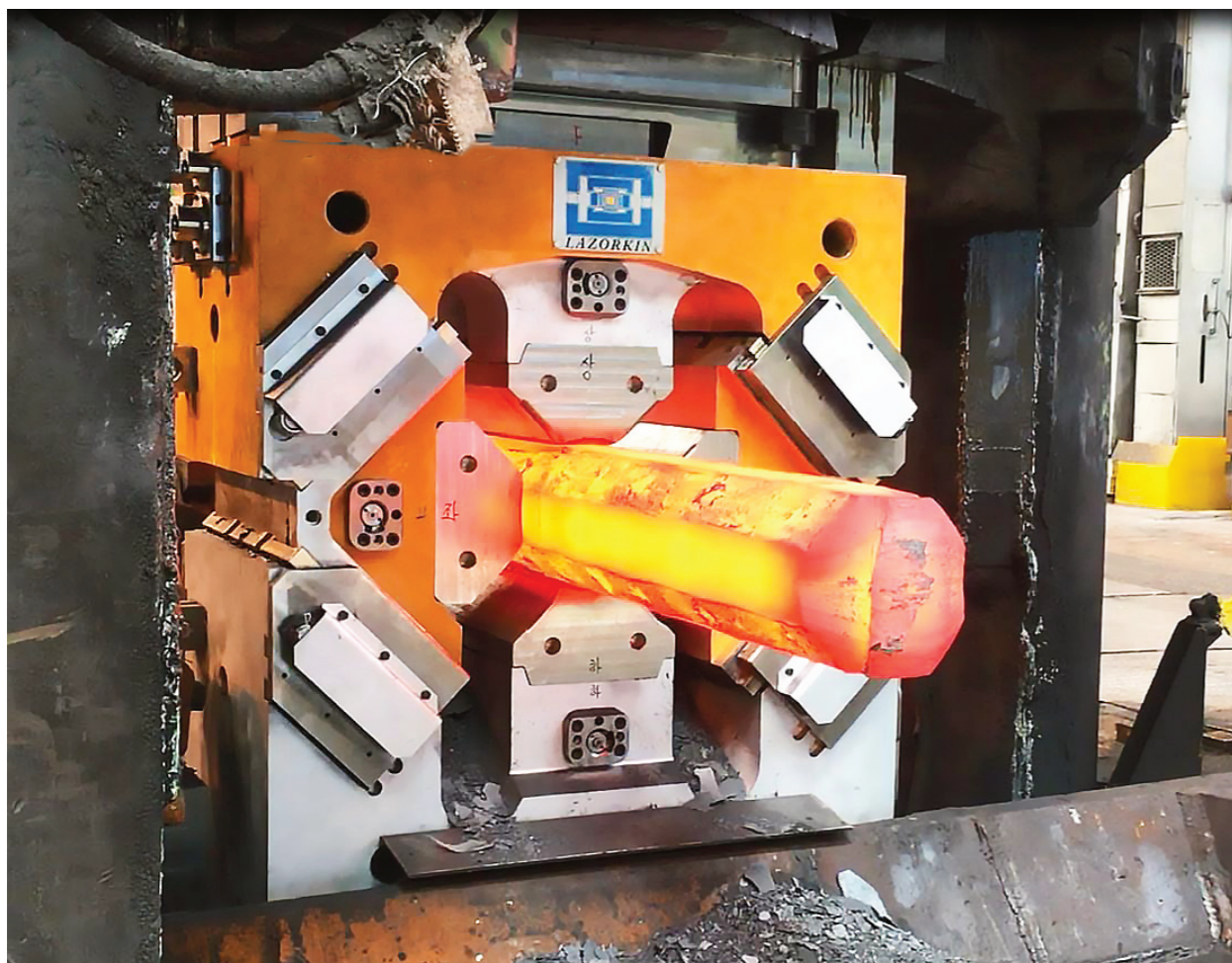
Ковка жаропрочного сплава в FDFD на прессе ус. 22 МН (Корея)
