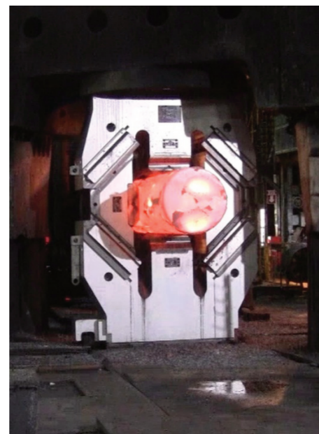
FDFD с бойками для получения поковок квадратного сечения и с бойками для получения поковок круглого поперечного сечения на прессе ус. 30 МН (Япония)
